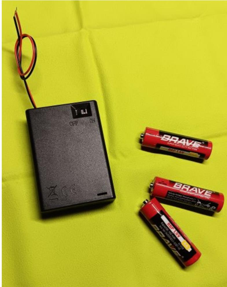
In diesem Fall stehen also durch Reihenschaltung innerhalb des Batteriehalters 4,5 Volt zur Verfügung. Der Anschluss erfolgt in diesem Fall natürlich nicht über den USB-Port, sondern über die Versorgungs-Pins des Digispark (siehe später).
